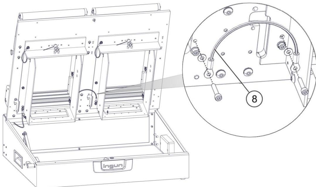
**c) Verdrahtung der FB-SLV-MAxx13T hinten und an den Kippleisten**
