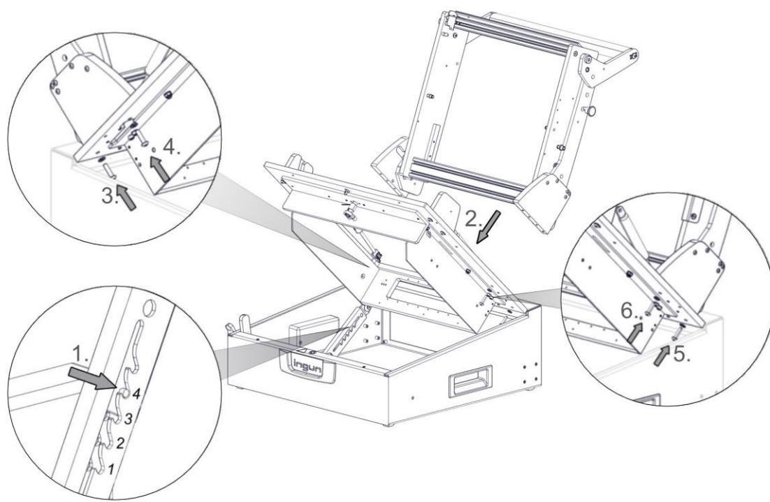
**17) Linke Schenkelfeder für Kippleiste einbauen**
