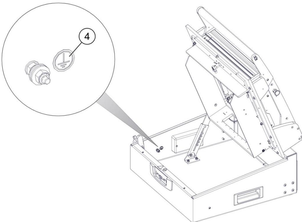
**29) Gewinde für Zylinderkopfschraube schneiden zum blockieren des Spannhebels (nicht bei MA 20xx)**
