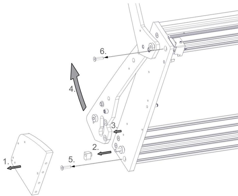
**6) Eloxalschicht in 90° Senkung entfernen**
