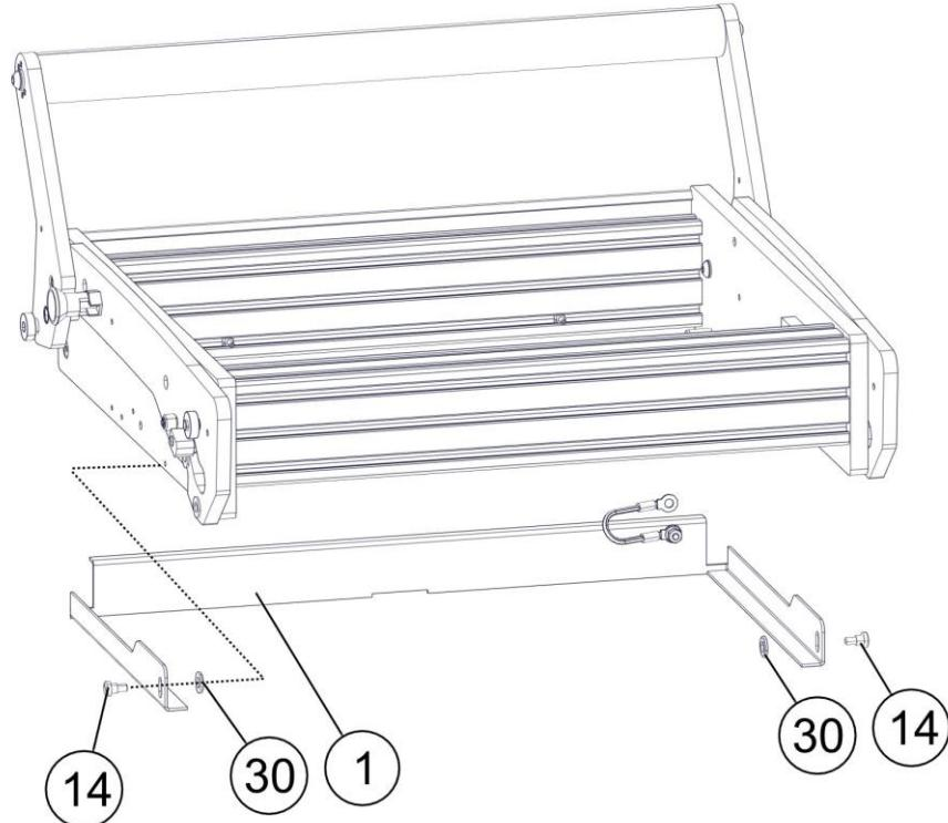
**12) Schutzleiter für Kippleiste mit Rahmen verbinden**
