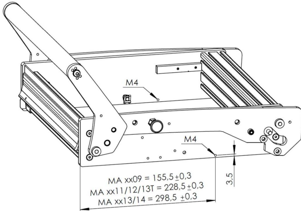
**8) Gewinde für Linsenschraube zum verschließen der Bohrung schneiden**
