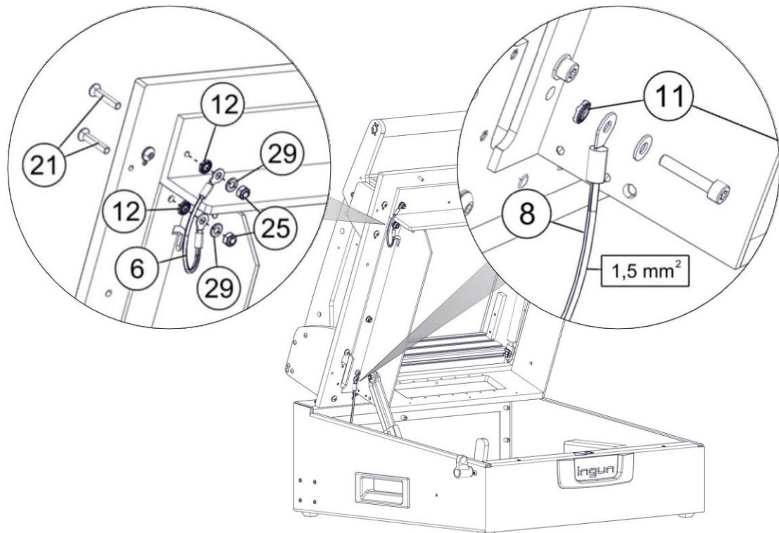
**23) Kontaktscheiben bei Schnittstellenplatte einbauen**
