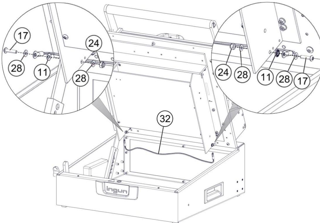
**25) Bohrungen mit Linsenschrauben verschließen**
