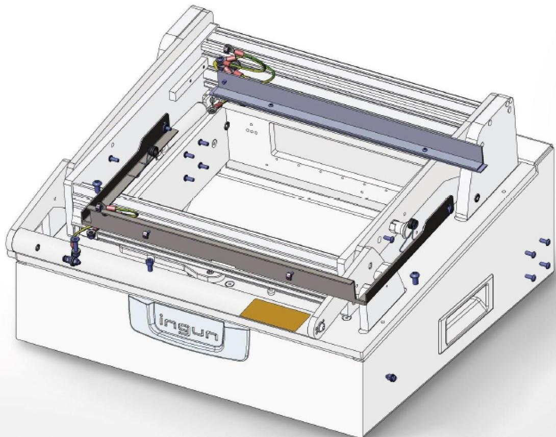
**DE** In dieser Montageanleitung wird gezeigt, wie die Funktionsbaugruppe „Schutzleiterverdrahtung und Berührungsschutz für gefährliche Spannungen (SLV-Ausbau)“ in den INGUN Prüfadapter MA xxxx eingebaut wird.
