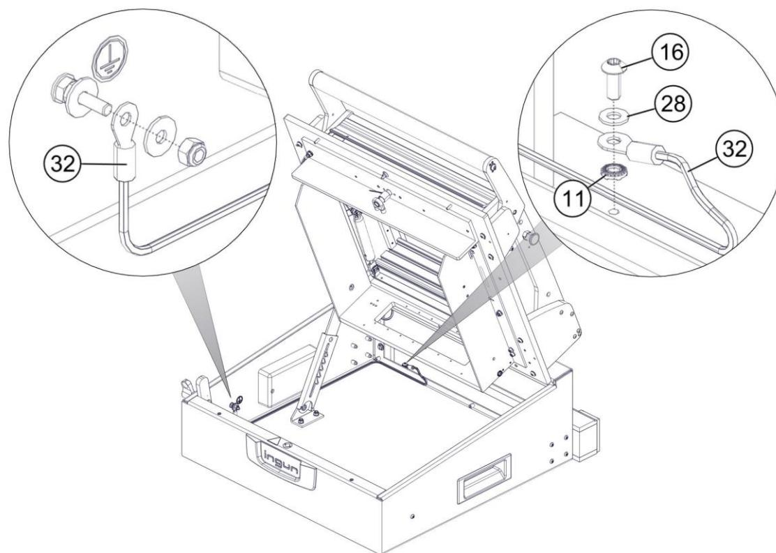
**A3) PE-Messung der Pylon- oder GR 2270/71-Testsystem-Schnittstelle**
