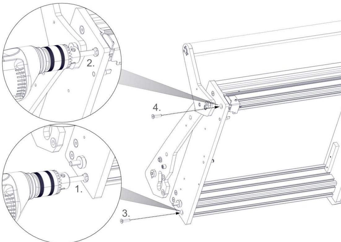
**7) Gewinde für Kippleiste bohren**
