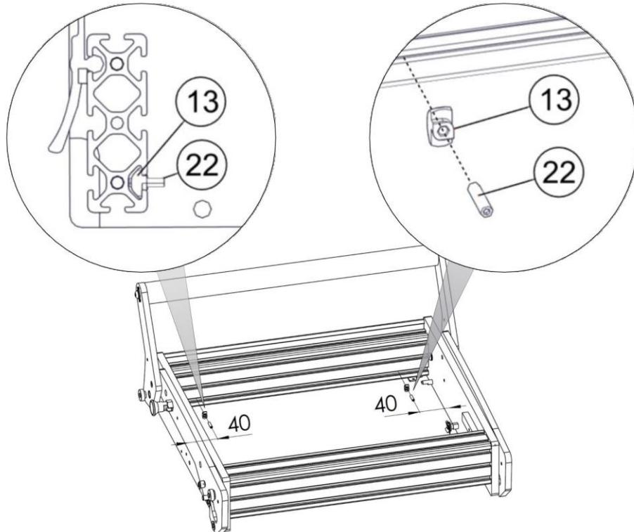
**10) Kabel an Kippleiste montieren**
