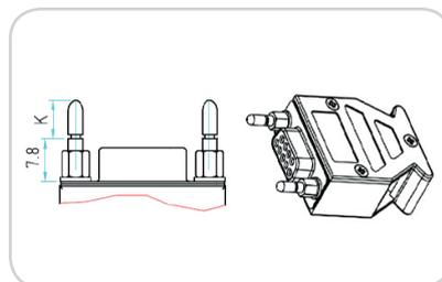
Montage en traversée de cloison liaison directe capot à capot.
