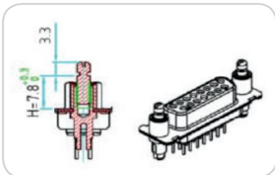
Montage sur carte avec clips de fixation sur PCB et filetage sur face arrière du connecteur.
