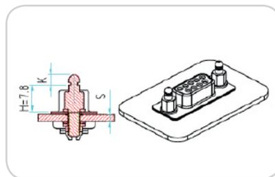
Montage sur carte avec clips de fixation sur PCB sans filetage et montage sur panneau face arrière.
