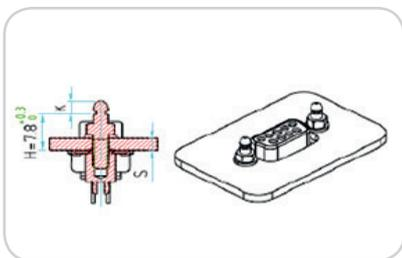
Montage sur carte avec clips de fixation sur PCB sans filetage et montage sur panneau face avant.
