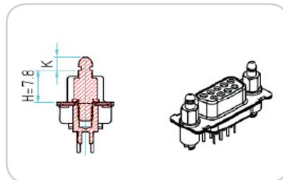
Montage sur carte avec clips de fixation sur PCB et filetage sur face arrière du connecteur et montage sur panneau face arrière.
